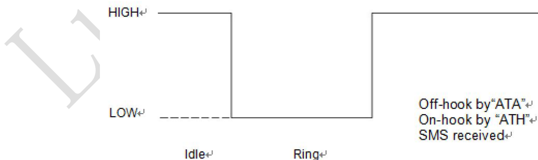
图表 10: 语音呼叫时模块用作被叫方 MAIN_RI 时序
